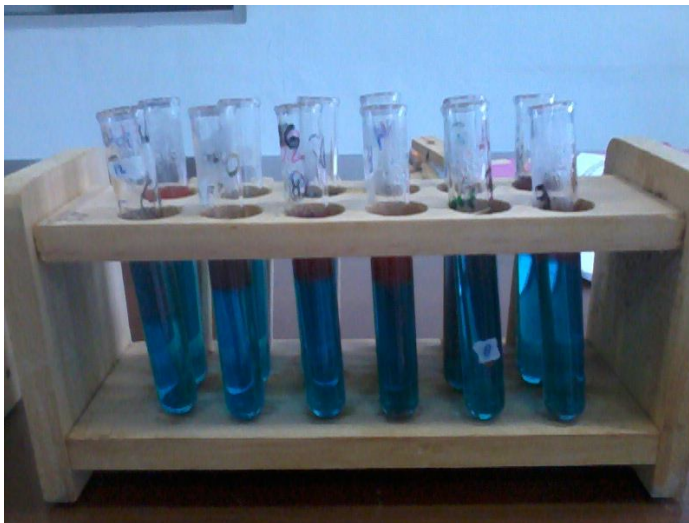
Gambar 2. Larutan benedict yang sudah di tetesi larutan glukosa yang diencerkan dan di panaskan di waterbath
