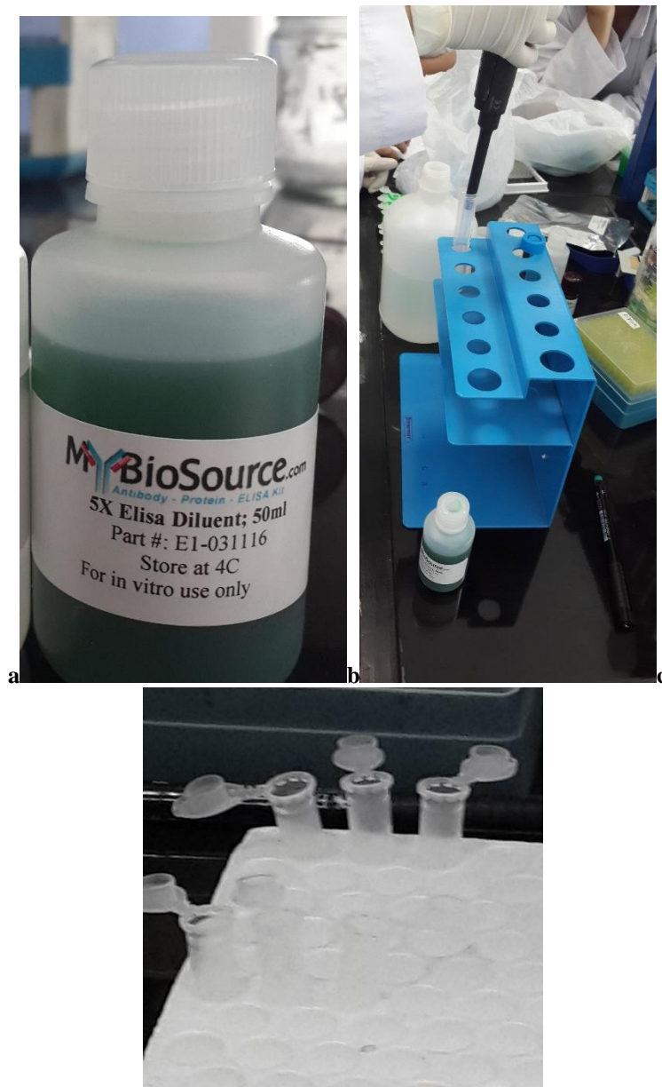
Gambar 3. a. Stok 5x ELISA Diluent b. Pengenceran 5x Diluent menjadi 10 ml 1X diluent (dengan menambahkan 2 ml 5I diluent dengan aquadest sebanyak 8 ml) c. Pengenceran sampel plasma dan serum
