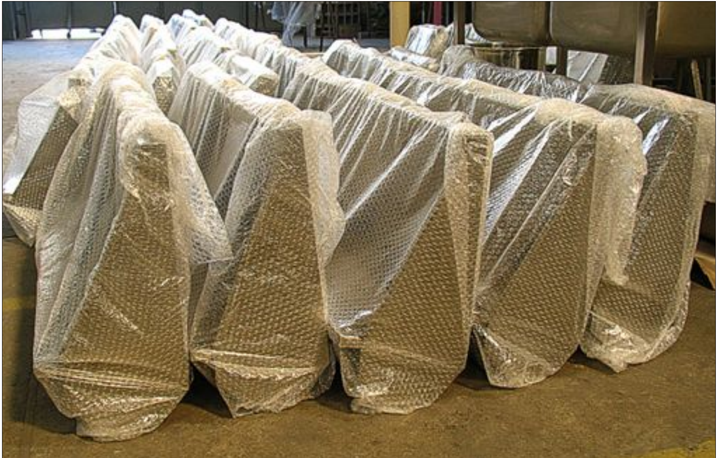
Mictórios Padrão Palmetal prontos para montagem no container banheiro a ser enviado ao Haiti
