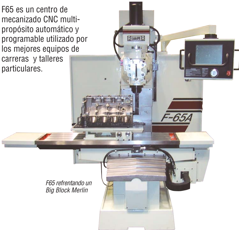
El Dispositivo de Precisión toma como referencia las líneas de centro del cigüeñal y el eje de levas para las operaciones de mecanizado.
