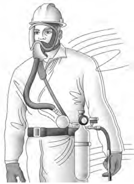
Respirador de máscara completa con suministro de aire con una botella de escape
