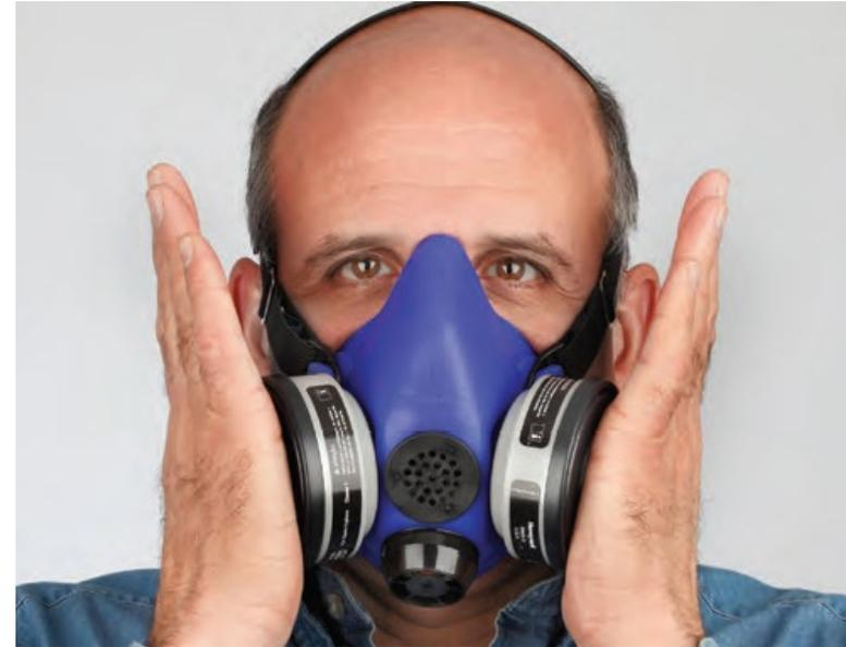
Presión negativa: Coloque la palma de cada mano sobre los dos cartuchos o filtros hasta que queden completamente sellados e inhale. Contenga la respiración durante 5 segundos. Si el sellado es correcto, la pieza facial se moverá hacia adentro, hacia su cara.
