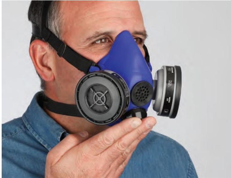
Presión positiva: Coloque la palma de la mano sobre la válvula de exhalación hasta que quede completamente sellada y exhale suavemente. Si el sellado está correcto, la pieza facial se expandirá ligeramente de la cara.
